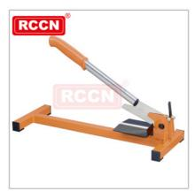
这款剪刀带45°和90°挡铁。适合剪切大尺寸的板条,木头、塑料、橡胶等制成的条板,并可以帮助减轻在剪切坚硬平整的材料时体力消耗。整体长度58cm,剪切长度130mm重量3200g。
