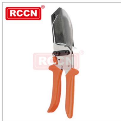
这款剪刀具有的杠杆作用，可以帮助在剪切坚硬平整的材料时减轻体力消耗。带90°挡铁。适合直角剪切由塑料制成的坚硬平滑的材料，如电缆槽和铁丝线。剪刀长度24.5cm，重量415g。所有部件均可分别拆卸，并且替换简单便捷。
